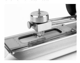
Bedecken Sie den Finger mit dem ungefärbten Reibgewebe und sichern seine Position mit Hilfe des dafür vorgesehenen Federclipses. Senken Sie den Kopfaufbau auf die Reibfläche und beginnen Sie mit der geradlinigen Bewegung durch Drehen des Griffs im Uhrzeigersinn wie durch den Pfeil angezeigt.
