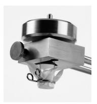
Der Reibfinger kann durch das Drehen der "Klemm-Schraube" gegen den Uhrzeigersinn entfernt werden, während der Klemmdruck gelöst ist. Ersetzen Sie den Reibfinger. Legen Sie den Klemmdruck wieder an, um den Finger zu sichern, indem Sie die Klemm-Schraube im Uhrzeigersinn drehen. Wird ein Reibfinger durch einen anderen ersetzt, muß die Spitze des Fingers abgerieben werden, bis sie parallel ist zur Prüflings-Halte-Platte.
