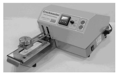
Materialien zu entsprechen. Das kombinierte und effektive Einspannen der einfach zu bedienenden Probenklemme aus Plexiglas und dem synthetischen Scheuerpapier macht das **Crockmaster** verwendbar für Textilien aus allen möglichen Fasern, in Form von Garn oder Gewebe, egal ob gefärbt, bedruckt oder anderswie farbig.
