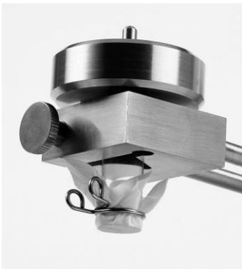
Pour enlever le doigt frottant, tourner la vis de serrage dans le sens inverse des aiguilles d'une montre pour relâcher la pression de serrage . Enlever le doigt, mettre le nouveau à sa place et reserrer la vis serrage.
