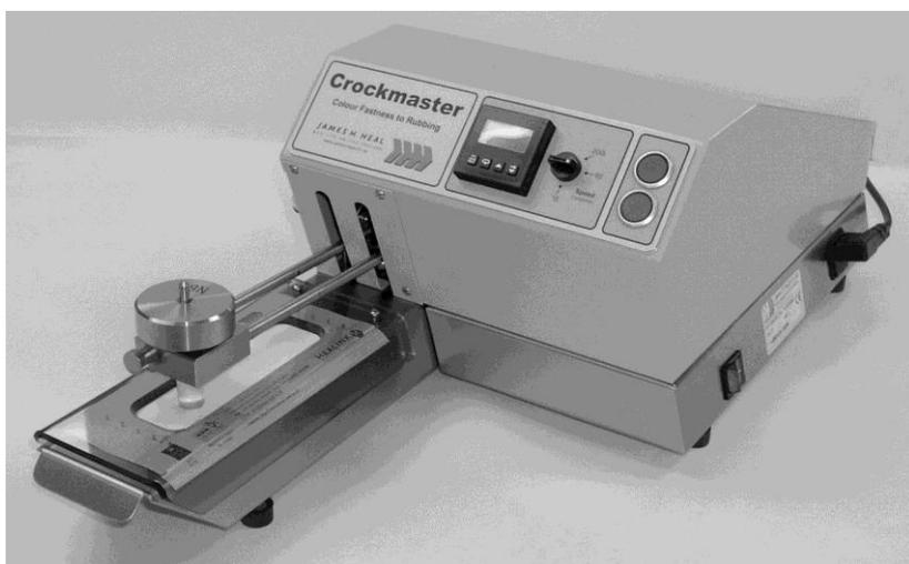
La combinaison efficace du serre-éprouvette en polycarbonate et du papier abrasif synthétique produit une force suffisante pour permettre l'application de l'appareil aux textiles composés de toutes sortes de fibres, sous forme de fil ou de
