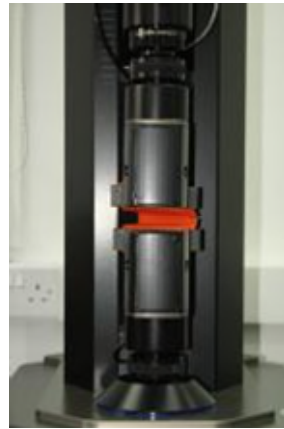
Trapezoidal tear specimen EN 1875-3
